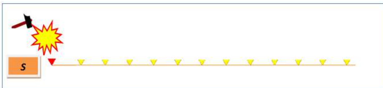
Figura 4 - Stendimento sismico per i primi 12 geofoni, rappresentati in giallo e posti a distanza costante di 3.5 m. A sinistra del trigger è posta la massa battente che costituisce la sorgente di energizzazione; a destra è collocato il sismografo per la registrazione dei segnali sismici.
