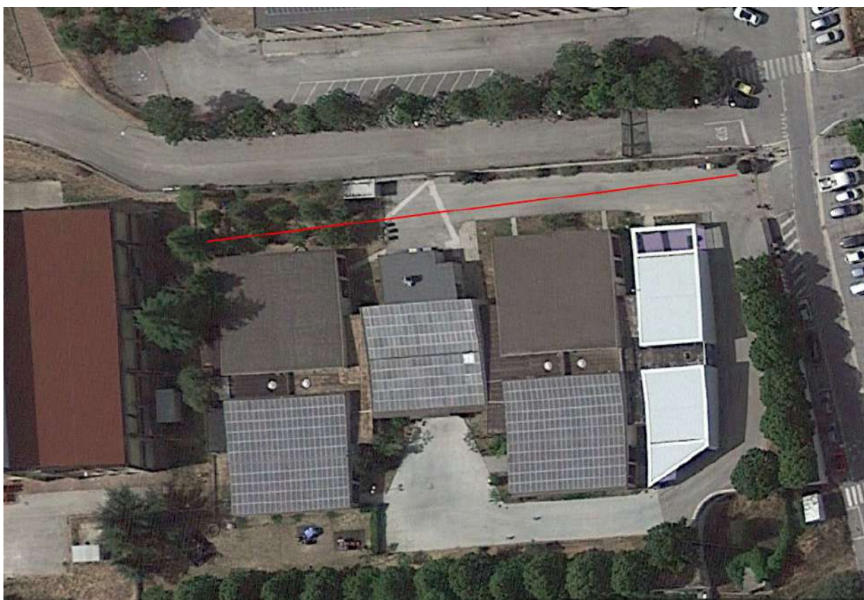
Figura 3 - Snapshot Immagine satellitare (2021) con ubicazione dell'indagine sismica MASW (linea rossa) rispetto all'edificio scolastico d'interesse.
