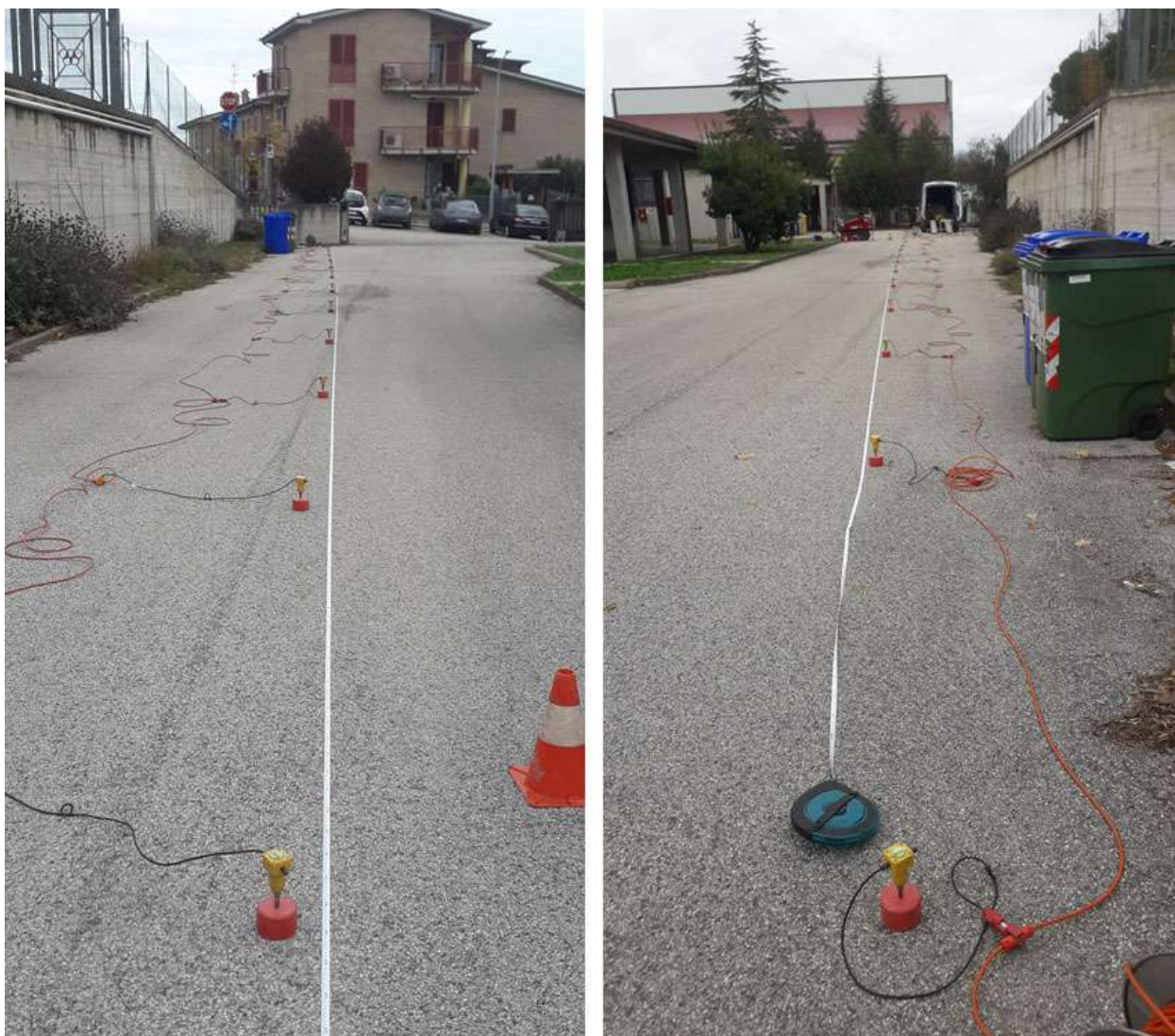
Figura 6 - Stendimento sismico lineare realizzato in sito.
