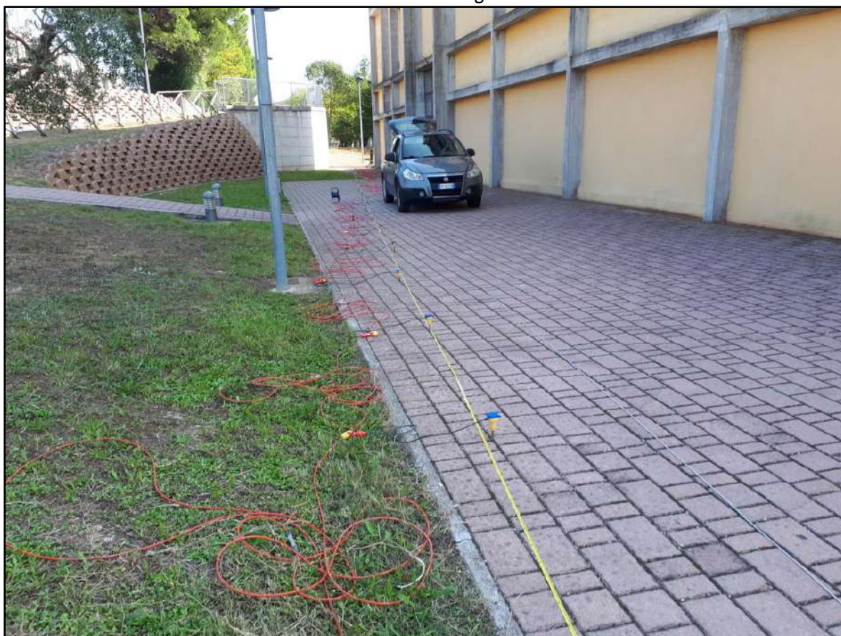
Foto 3: Stendimento sismica a Rifrazione e MASW
