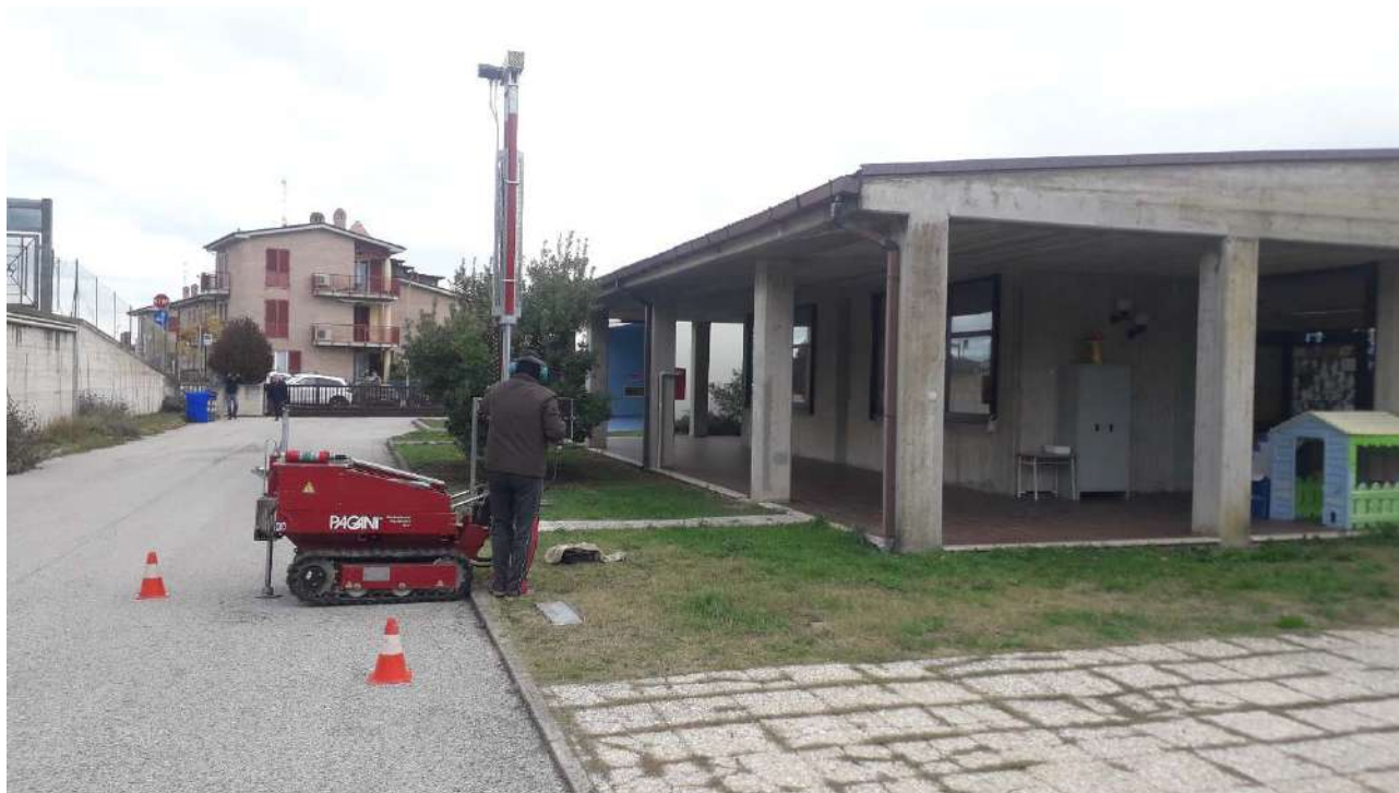
Figura 4 - Ubicazione della prova penetrometrica dinamica super pesante (DPSH, SCPT) P1
