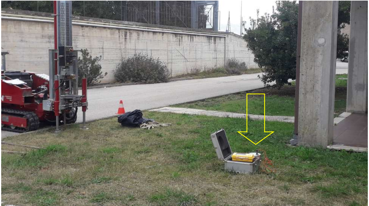
Figura 4 - Ubicazione del sensore di superficie 3D-2Hz per l'indagine sismica HVSR (freccia gialla).
